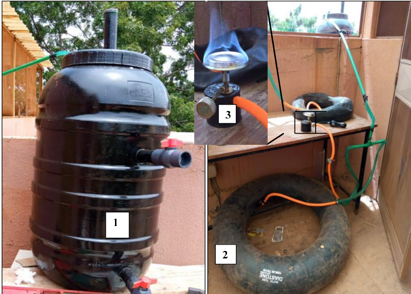
Figure 2 : Images montrant (1) Biodigesteur (2) Chambre de stockage du biogaz (3) Brûleur
