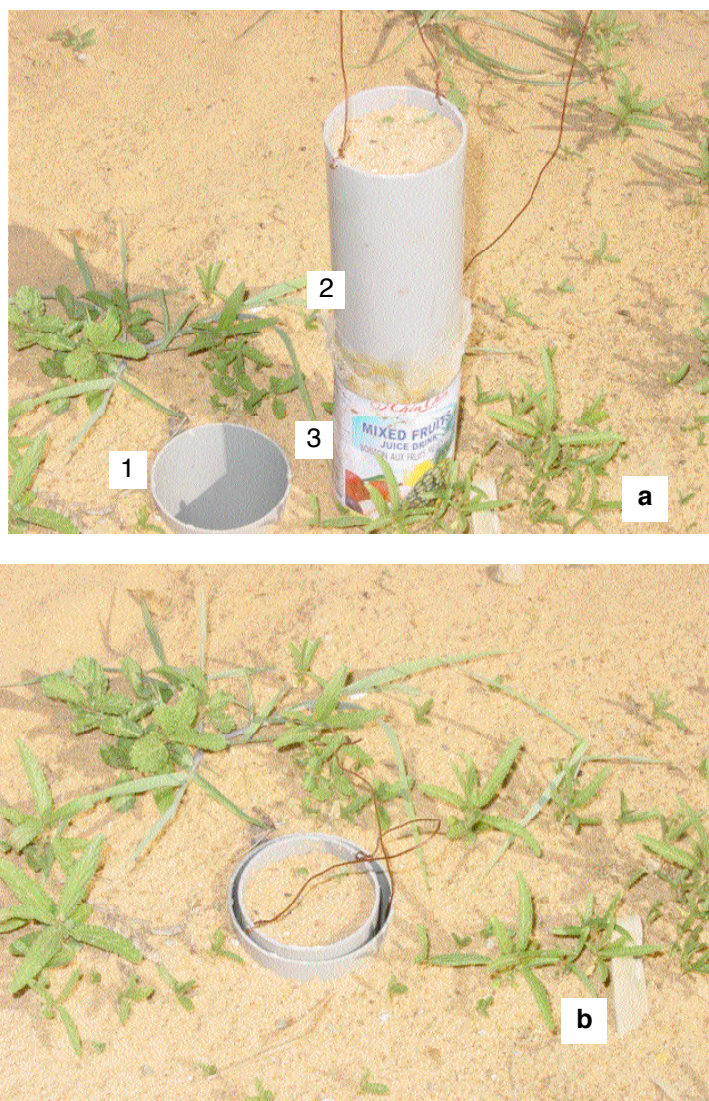
Photo 1. Eléments constitutifs des micro-lysimètres confectionnés pour mesurer l'évaporation du sol. AGRHYMET, 2003.
