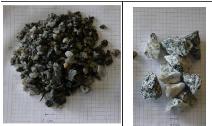
Photo 2 : Granite de diamètre 6/15 mm à gauche et 30/60 mm à droite
