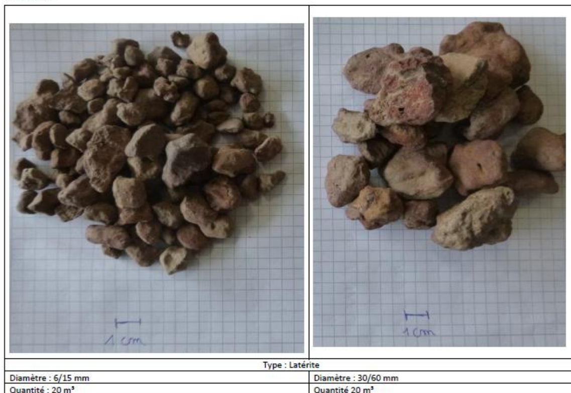
Photo 3 : Latérite de diamètre 6/15 mm à gauche et 30/60 mm à droite
